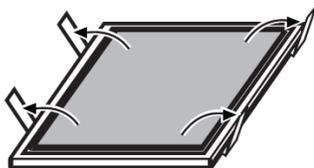
3. Coloque el filtro de carbón en la parte superior del filtro metálico.
